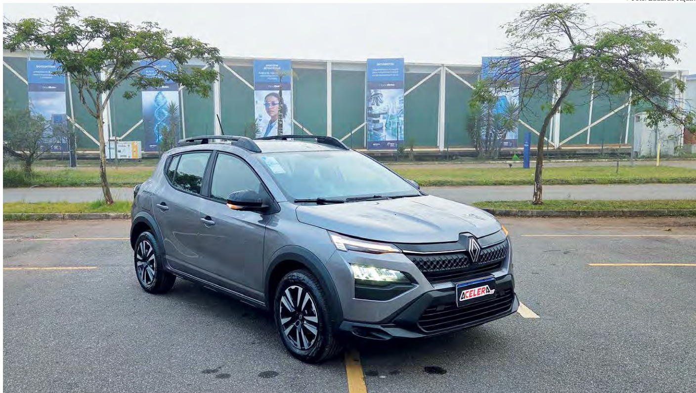
No controle: O Renault Kardian Evolution combina motor 1.0 turbo de 125 cavalos de potência com câmbio manual de seis marchas
